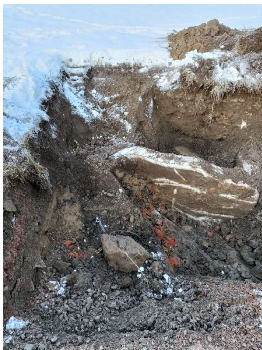
Kuva 5. Tutkimuspiste SW5. Tutkimuspisteessä havaittiin perustuksia ja romukaapeli. Myös tiiltä oli hieman joukossa.
